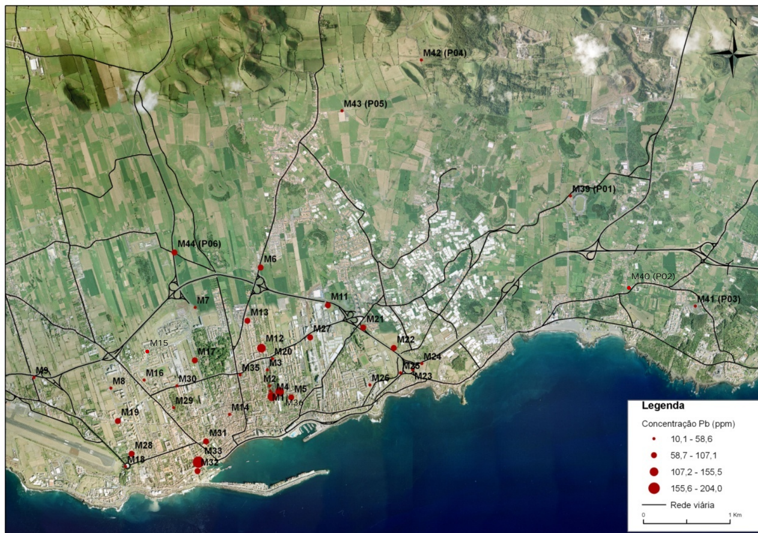
Fig. 7.6 - Distribuição espacial das amostras colhidas na zona urbana de Ponta Delgada e as respectivas concentrações de Pb (ppm).
