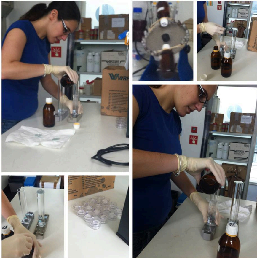
Figura 3 - Preparação das amostras de fitoplâncton para serem visualizadas no microscópio de inversão com contraste de fase.
