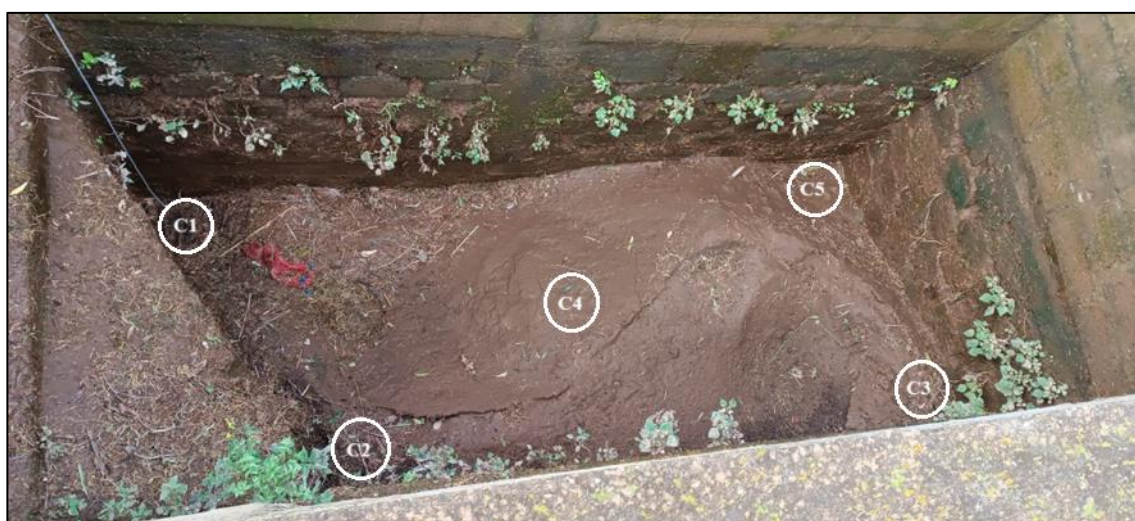
Figura 4.13 | Fotografia do interior do poço com as localizações de cada medição de concentração de gás efetuada. Fotografia de 11/02/2024.
