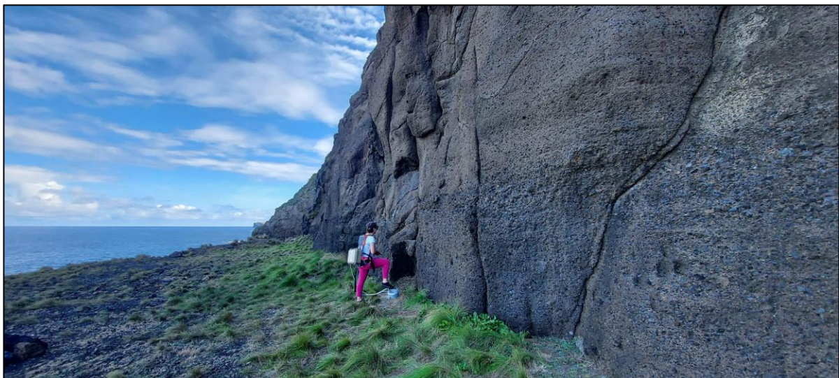
Figura 3.2 | Medição de fluxo de CO 2 no solo executada na zona da Ferraria (ilha de S. Miguel, Açores), recorrendo ao método da câmara de acumulação.
