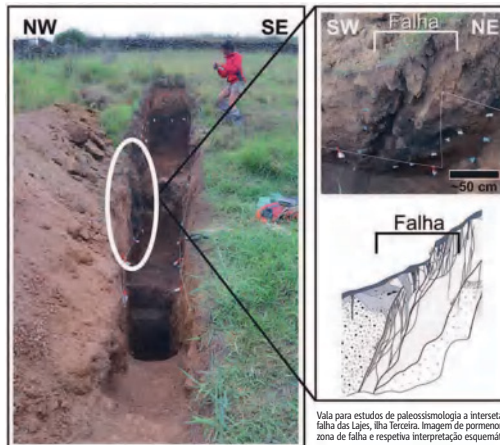
Figura 1 - Vala para estudos de paleossismologia a interseção da falha das Lajes, ilha Terceira. Imagem de pormenor da zona de falha e respetiva interpretação esquemática.
