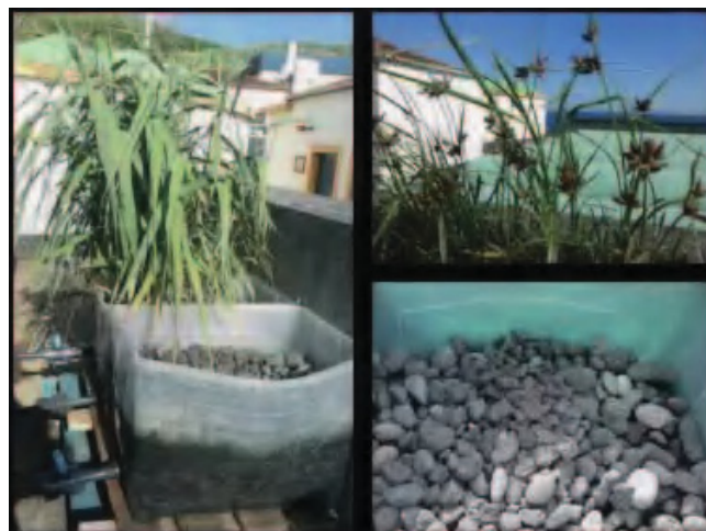
Figura 9 - Ensaio piloto de Zona Húmida Construída para tratamento complementar de água residual
