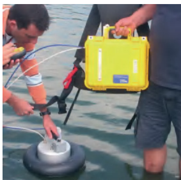
Figura 1 - Medição de fluxo de \text{CO}_2 com recurso a estação portátil com câmara de acumulação flutuante
