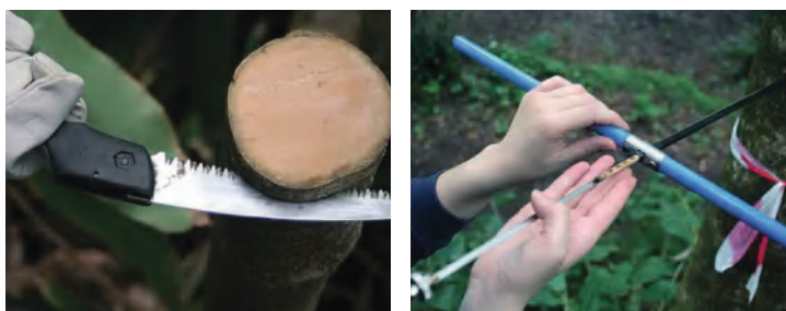
Figura 1 - Utilização de cortes transversais do tronco para a recolha de cilindros de madeira e utilização de uma sonda de Pressler para a recolha de amostras radiais a partir do tronco de árvores de incenso, no sentido de estimar a idade das árvores, as taxas de crescimento e o período de rotação, com o intuito de avaliar a biomassa disponível para a valorização energética.
