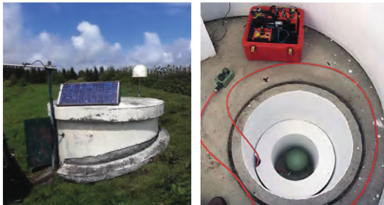
Figura 2 - Cave sísmica (esq.) e sismómetro de banda larga (dir.) pertencentes à Rede Sísmica Permanente do CIVISA
