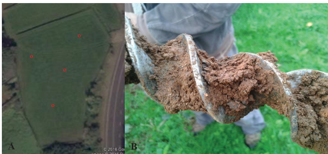
Figura 37 - A) Imagem com pontos representativos das zonas de colheita; B) Sonda helicoidal utilizada para a recolha de amostras.
