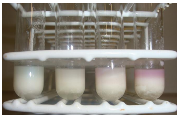
Figura 3.1. Classificação das diferentes tonalidades do vermelho no teste de verificação da produção de diacetilo. Da esquerda para a direita: negativo, positivo fraco, positivo médio e positivo forte.
