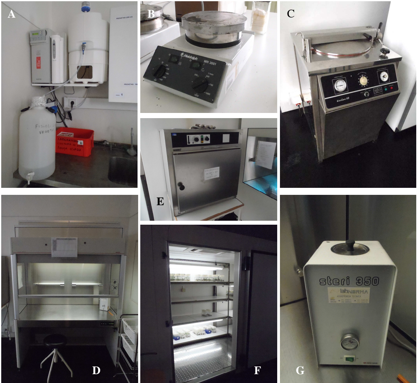
Figura 5. Equipamento: A) Bidestilador elétrico Millipore®. B) Termoagitador eletromagnético Heidolph®. C) Autoclave vertical semiautomático AJC®. D) Câmara de fluxo laminar horizontal Sanyo®. E) Estufa Memmert®. F) Câmara frigorífica industrial Evergreen Refrigeration®.G) Esterilizador elétrico Steri 350®.
