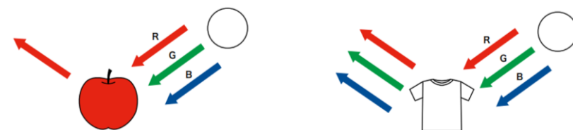
Figura 7 Modo de funcionamento de um sensor de cor
