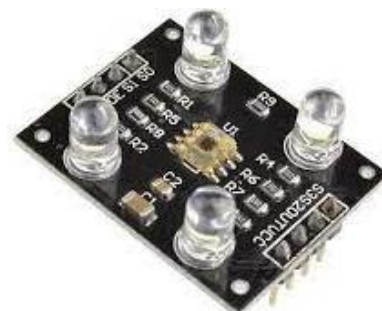
Figura 6 Sensor de cor TCS3200
