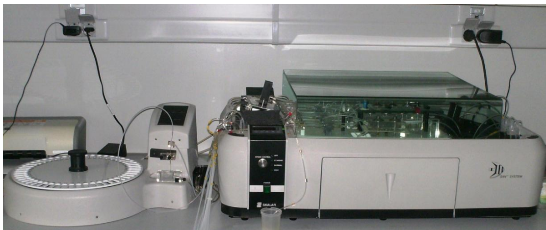
Figura 6 – Aparelho de espectrofotometria de absorção molecular em analisador automático de fluxo segmentado, utilizado para a determinação do N mineral.
