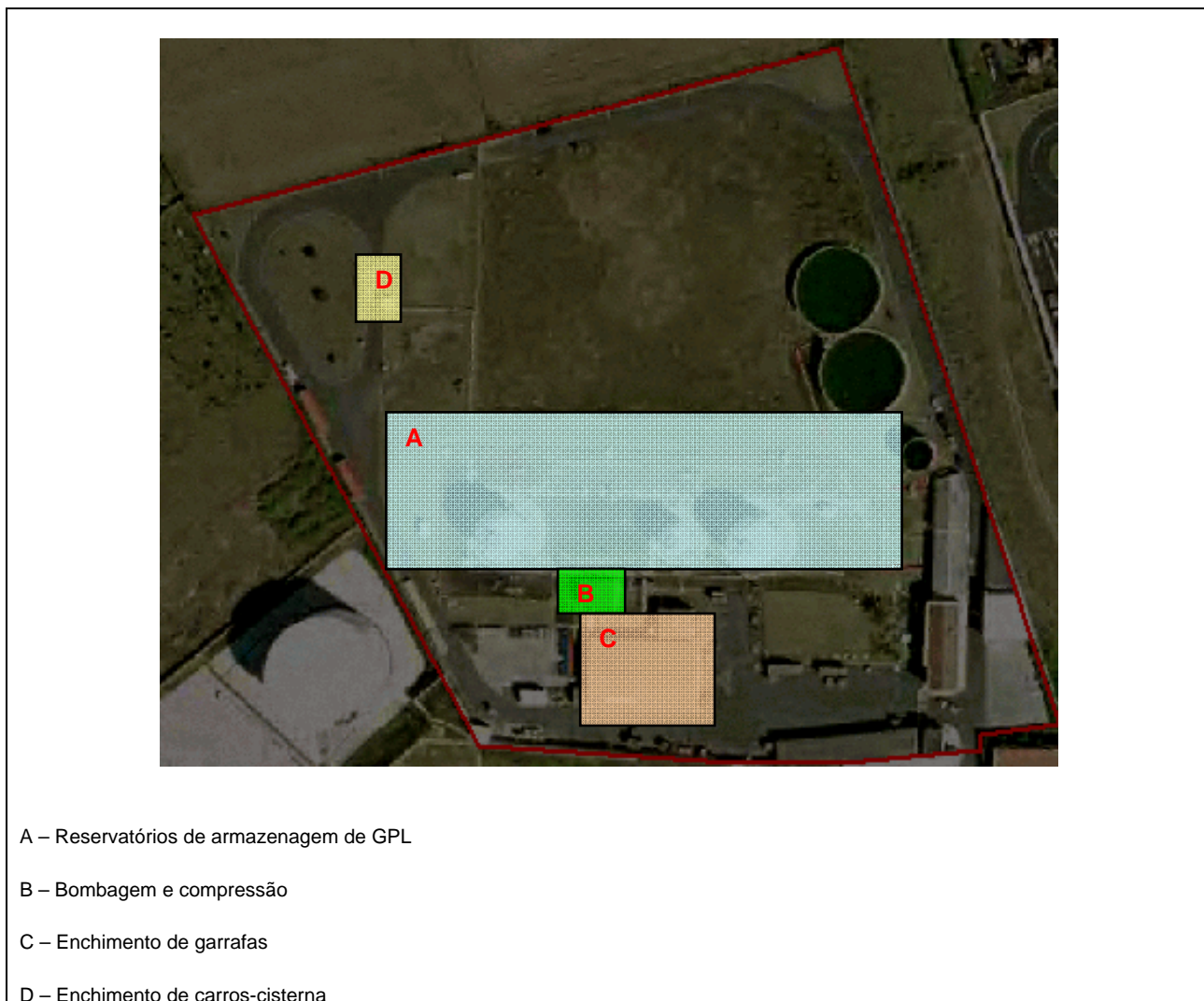
Figura 4.29. Parque de GPL da Nordela, SAAGA, S.A., onde se identificaram os vários locais, de acordo com a sua função ( http://sigweb.mpdelgada.pt/geoportal ).
