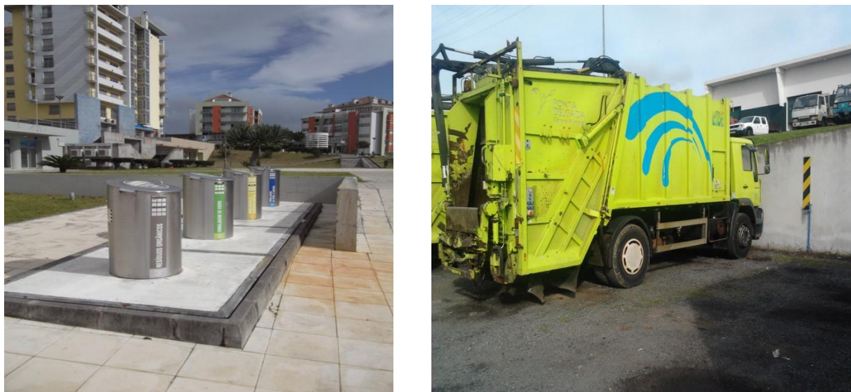
Figura 7. Ecoponto subterrâneo e veículo de recolha equipado com grua de elevação (Fotografias do Autor)
