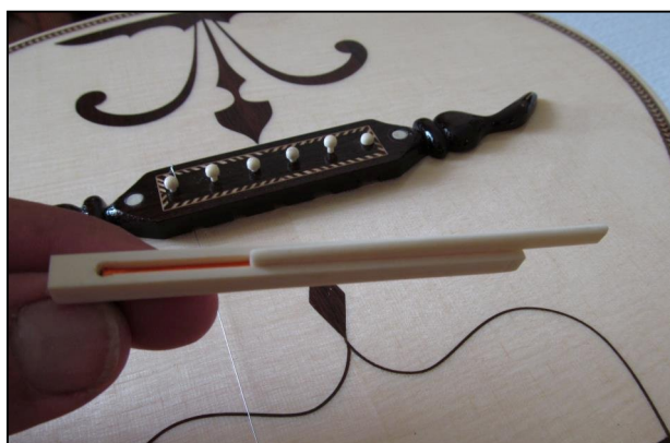
Fig. 48 – Detalhe do sistema de captação no cavalete. Foto de Raimundo Leonardes.
