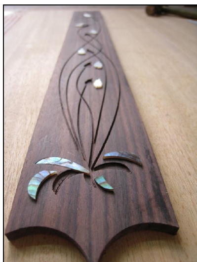
Fig. 47 – Detalhe do embutido da escala. Foto de Raimundo Leonardes.
