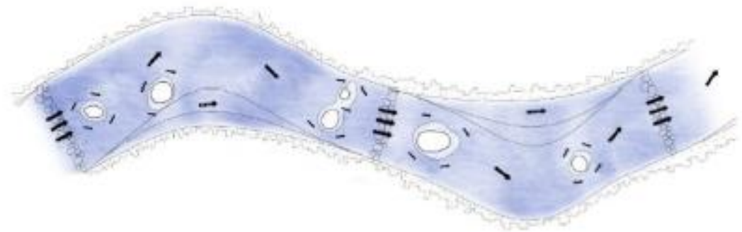
Figura 6.2 Método de colocação de blocos de pedra no leito de um rio (Baptista, 2023)
