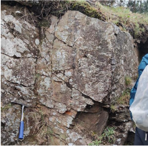
Figura 5.27 - Afloramento localizado ao lado da estrada no monte de Santa Marta na União das Freguesias de Nogueira, Fraião e Lamações, onde é possível observar o micaxisto alterado.
