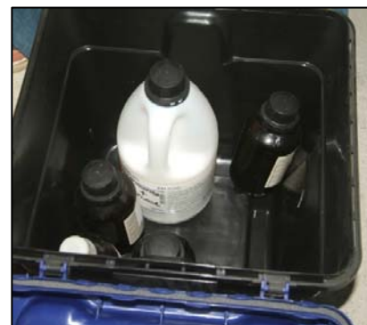
Figura 2 – Local de deposição de resíduos num laboratório, com contentores de resíduos laboratoriais (para líquidos ou sólidos) devidamente rotulados e recipientes individuais fechados e também rotulados no seu interior.
