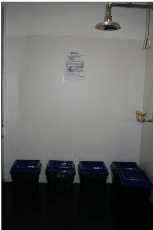
Figura 2 – Local de deposição de resíduos num laboratório, com contentores de resíduos laboratoriais (para líquidos ou sólidos) devidamente rotulados e recipientes individuais fechados e também rotulados no seu interior.
