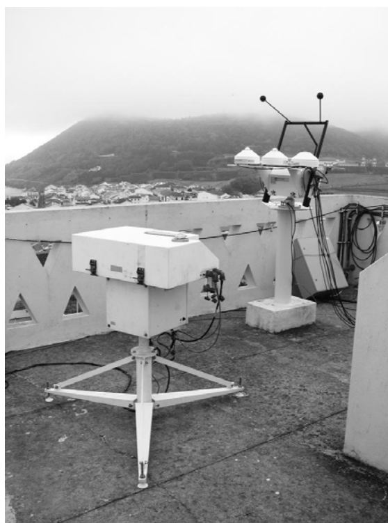
Figura 1. Vista da instalação do sun tracker com os sensores de radiação (à direita) e do espectrofotómetro Brewer (à esquerda) no terraço do Observatório José Agostinho (Angra do Heroísmo).
