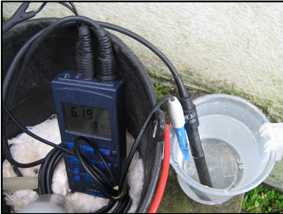
Figura 5.1. Determinação de pH e condutividade no campo com recurso ao medidor multiparamétrico WTW.
