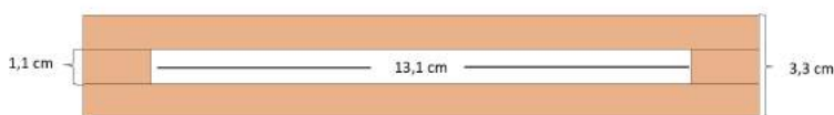
Figura 52: Esquema da base com calha para deslocar os cartões do dispositivo de algarismos móveis para dezenas e unidades.
