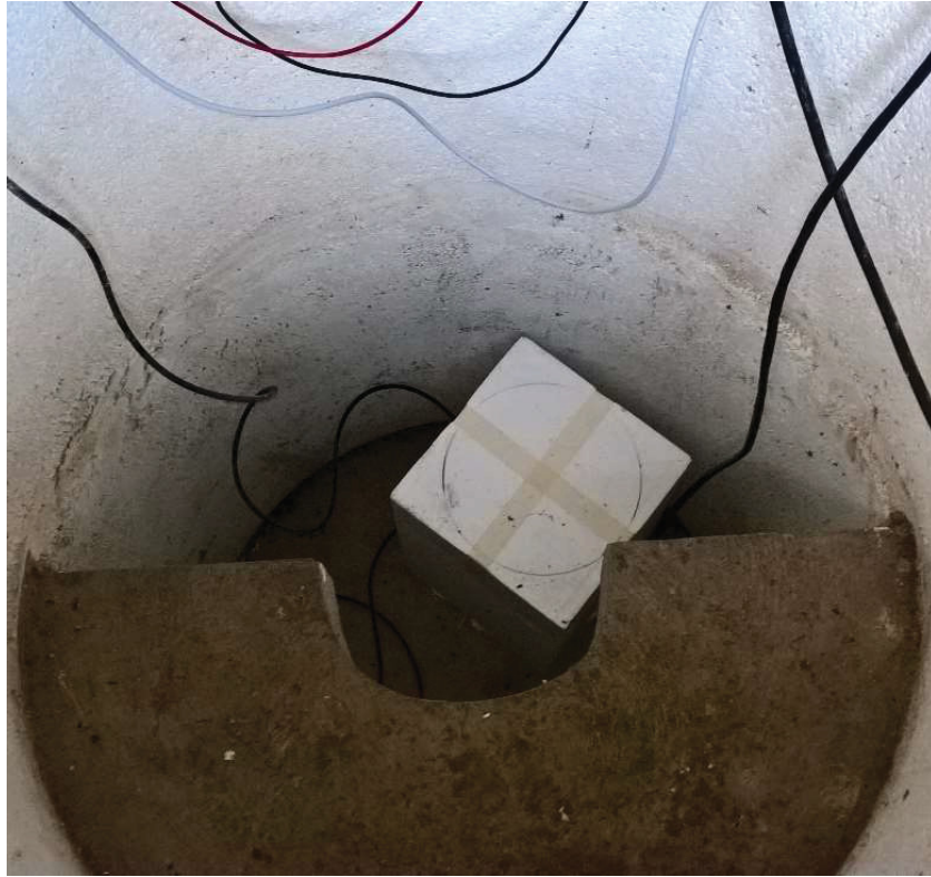
Figura 6.1 – Proteção térmica em poliestireno do sensor sísmico em SET2.
