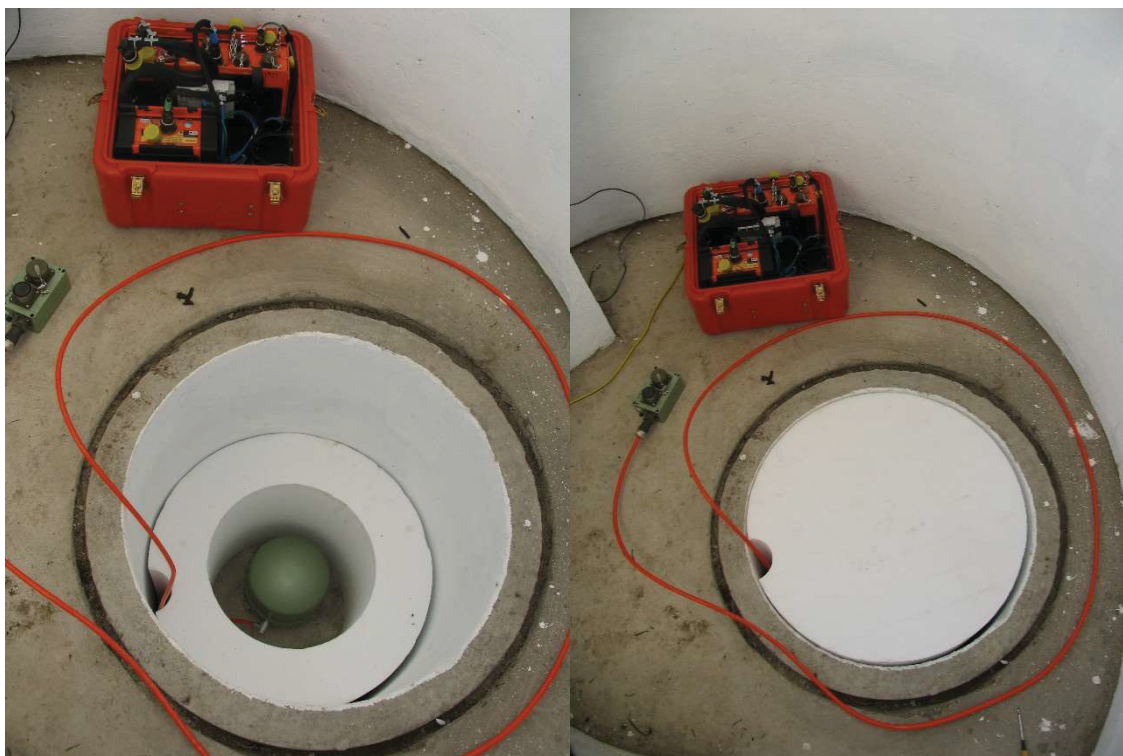
Figura 7.26 - Detalhe do fosso bem como da proteção térmica adaptada ao fosso e ao sensor.
