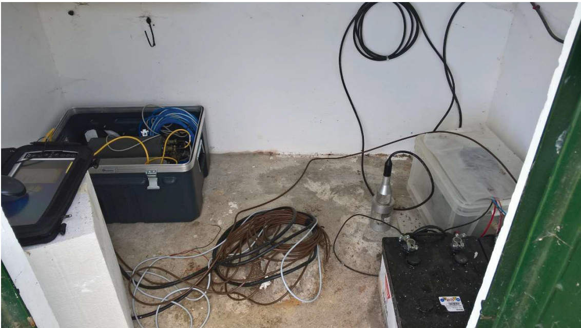
Figura 6.11 – Equipamento em PFET. Note-se a ausência de fosso, ficando todo o equipamento ao mesmo nível.
