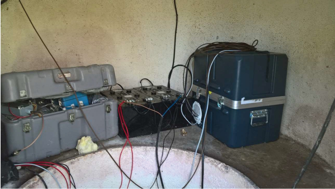
Figura 6.5 – Equipamento em SET2. À esquerda o equipamento de aquisição e transmissão de dados do sensor de curto período, ao centro as baterias ligadas aos painéis solares e à direita o digitalizador da estação de banda larga dentro da caixa de transporte.
