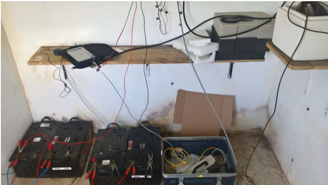
Figura 6.13 – Manutenção e recolha de dados em MESC. É utilizado um computador portátil para ligação ao digitalizador, permitindo assim controlar a estação e recolher os dados.
