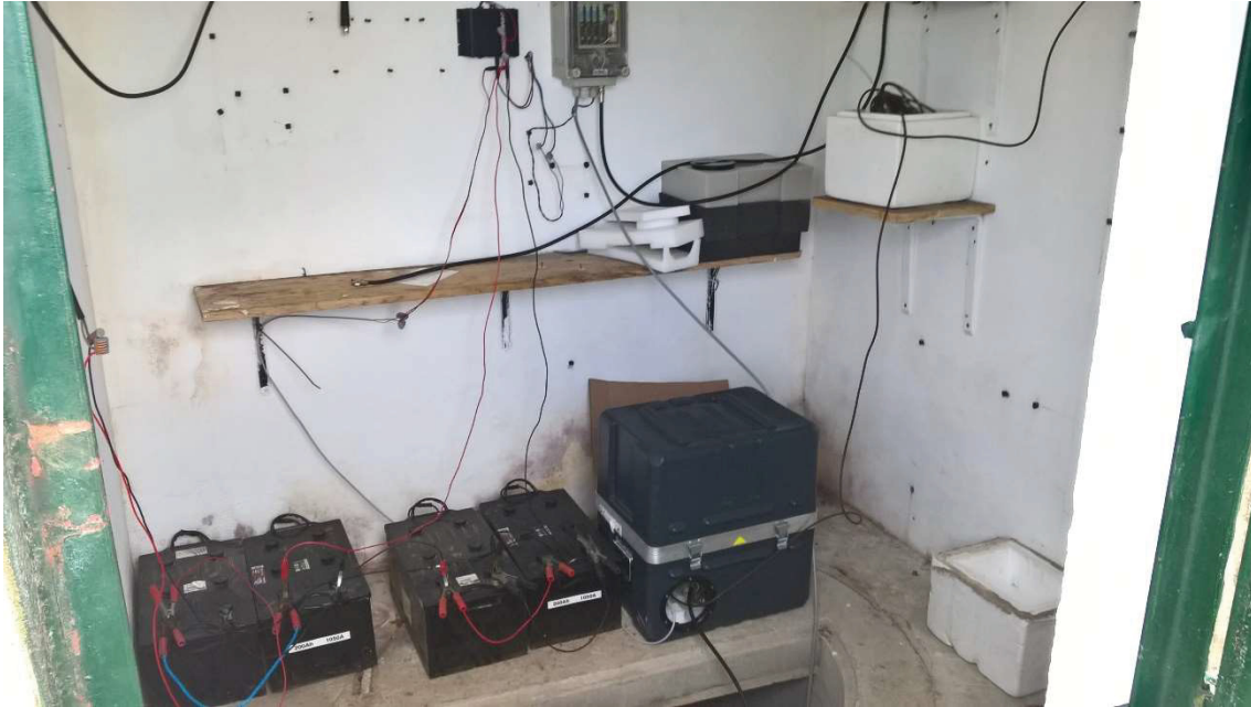
Figura 6.8 – Equipamento em MESC, já com as baterias extra ligadas e com o digitalizador dentro da caixa de transporte.
