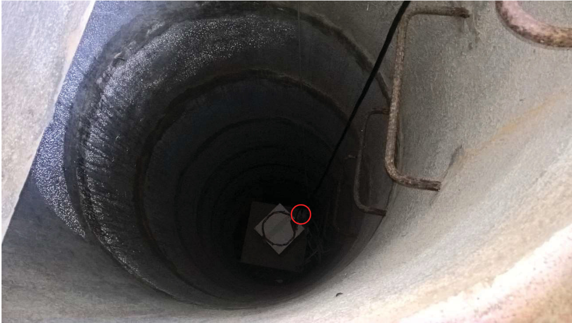
Figura 6.7 – Fosso em MESC. Visível a proteção térmica do sensor de banda larga. O sensor de curto período encontra-se no canto superior direito da base em betão, assinalado a vermelho.
