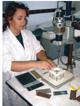
Fig. 3 - Preparação de provetes metálicos para análises de corrosão.
