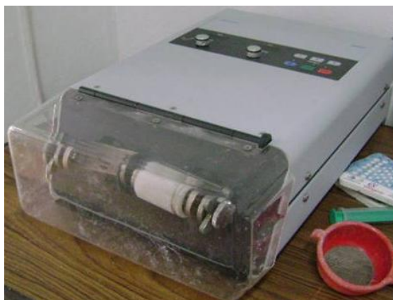
Figura 3.2. Moinho utilizado para triturar as bagas congeladas.
