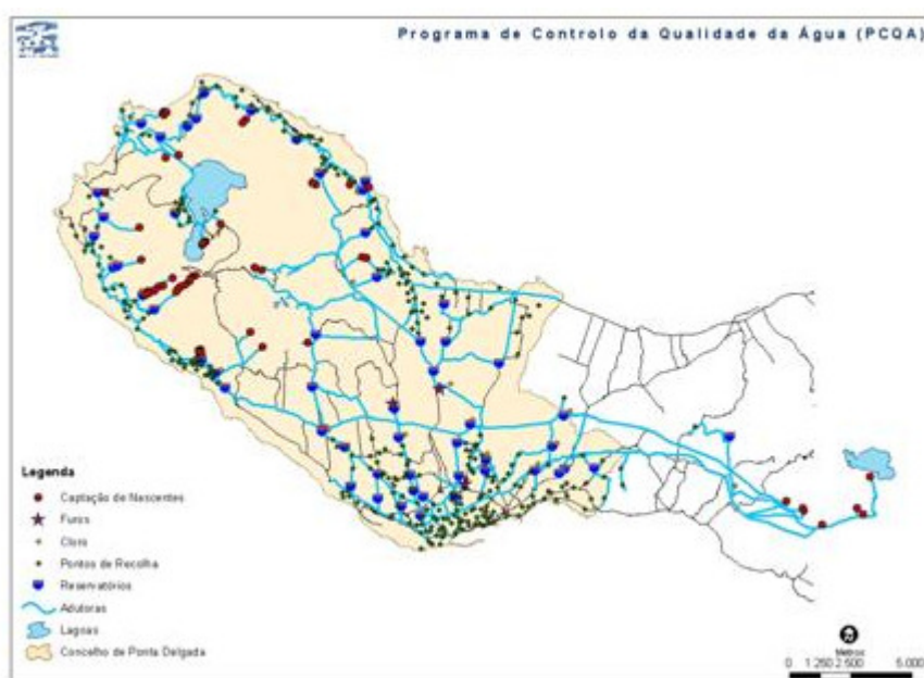
Figura 3.2 – Infra-estrutura de abastecimento de água do concelho de Ponta Delgada, incluindo os pontos de recolha para análise da qualidade
