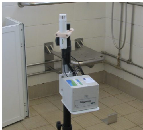
Figura 2. Aparelho, sensor combinado de temperatura e humidade relativa do ar da Skye Instruments Ltd. (rht+, SKH 2070/1). O equipamento de aquisição de dados, um datalogger DataHog 2 da Skye Instruments., programado para fazer leituras de 5 minutos em 5 minutos.
