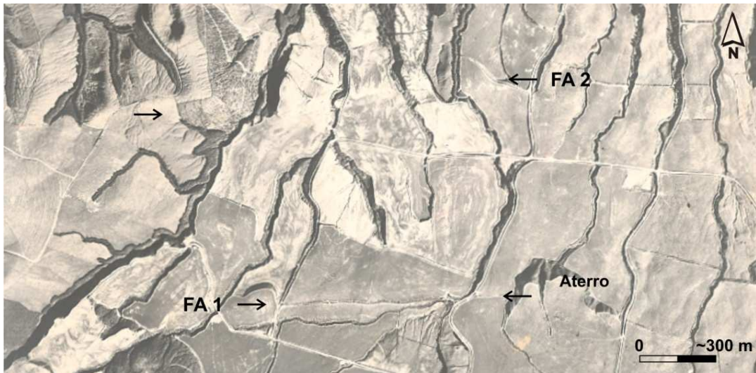
Figura 7.2 – Extracto da fotografia aérea de 1974, fiada 6E, à escala 1:15000, da zona do Altiprado, onde é possível observar as escarpas das falhas Altiprado 1 (FA1) e Altiprado 2 (FA2) (fotografia aérea da Direcção Geral de Planeamento Urbanístico).
