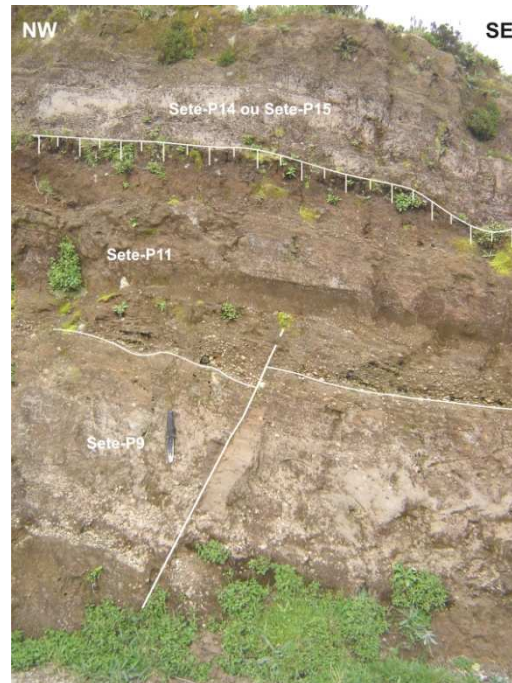
Figura 4.43 – Aspecto geral do corte da estação 183 onde se observa a Falha Sete Cidades 27 a afectar depósitos que parecem corresponder às unidades Sete-P9 e Sete-P11 definidas por Queiroz (1997). A escala mede 27 cm.
