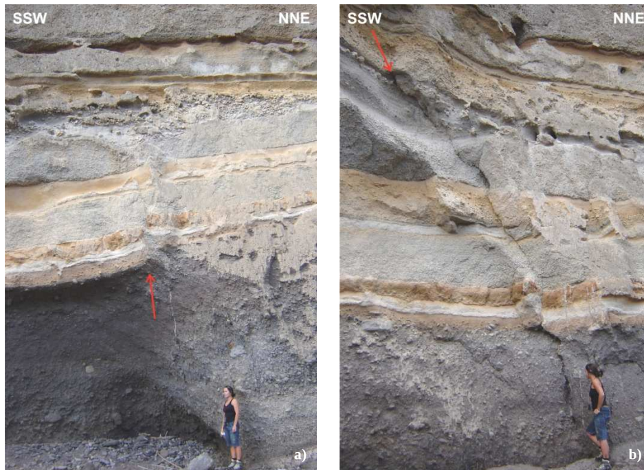
Figura 6.26 – Falhas Roída Praia 1 e 2 expostas na arriba litoral W da Praia da Pedreira (estação 126). O depósito da base corresponde às cinzas ignimbríticas do Membro Inferior da Formação da Roída da Praia (Wallenstein, 1999), datadas de 34200 anos BP. A escala mede 1.6 m.
