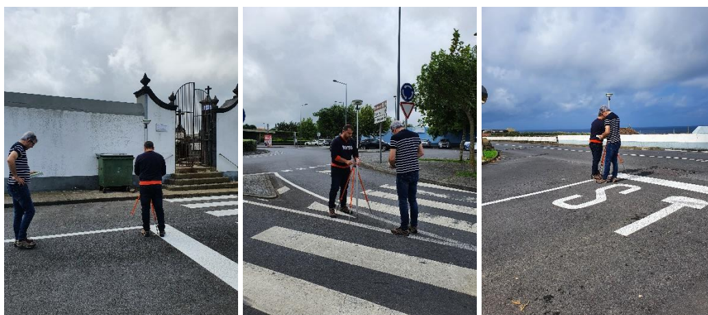
Figura 25 – Exemplos da escolha dos pontos de controlo de terreno.
