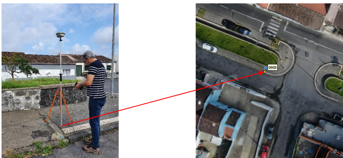
Figura 26 – Exemplos da georreferenciação de um ponto de controlo de terreno (dia 16/10/2021 na freguesia de Rabo de Peixe).
