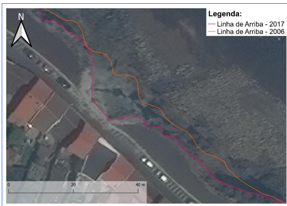
Figura 42 – Exemplo da erosão ocorrida no setor 3, freguesia de Rabo de Peixe, no período 2006 – 2017. Base: Ortofotomapa da área de estudo referente ao ano 2017, fornecido pela SRTMI.
