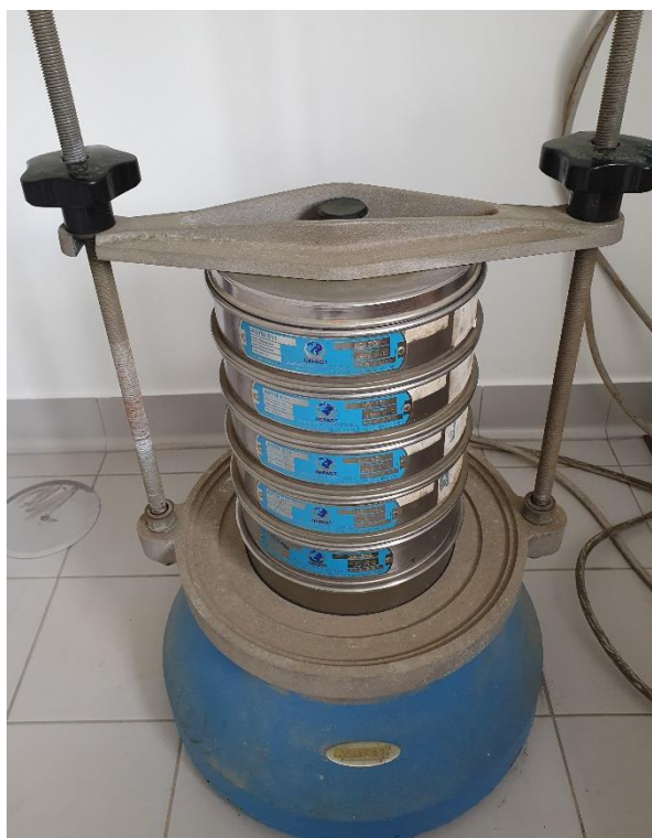
Figura 32 – Conjunto de peneiros da série ASTM e peneirador mecânico.
