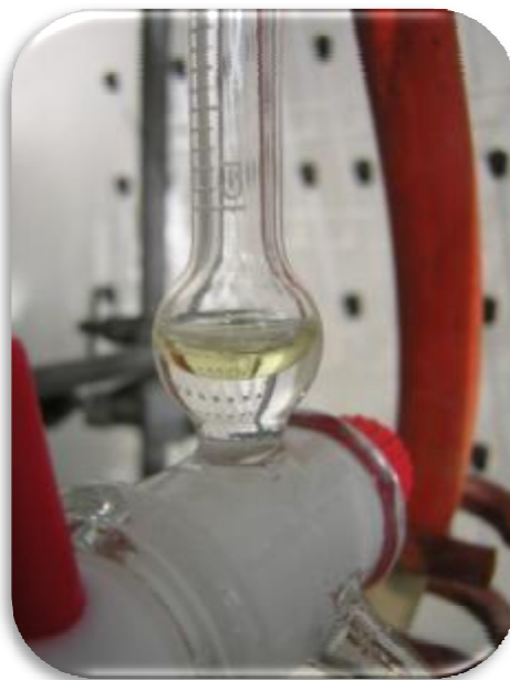
Figura. 1.7. Foto de óleo essencial de Hedychium gardnerianum extraído por hidrodestilação por um aparelho tipo Clevenger (Foto: Carmo Barreto)
