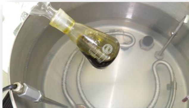
Figura. 2.4. Fotografia em pormenor da fracção metanólica no evaporador rotativo Büchi Rotavapor RE210 (Foto de: Autor)
