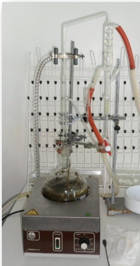
Figura. 2.5. Aparelho de Clevenger utilizado na extração dos óleos essenciais. (Foto de: Autor)
