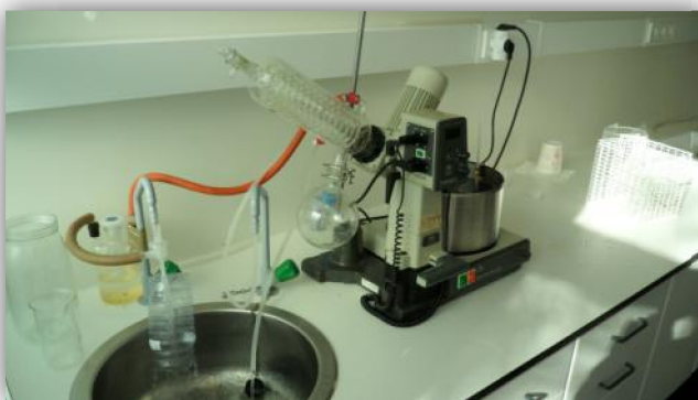
Figura. 2.3. Fotografia em pormenor da fracção diclorometânica no evaporador rotativo Büchi rotavapor RE121 (Foto de: Autor).
