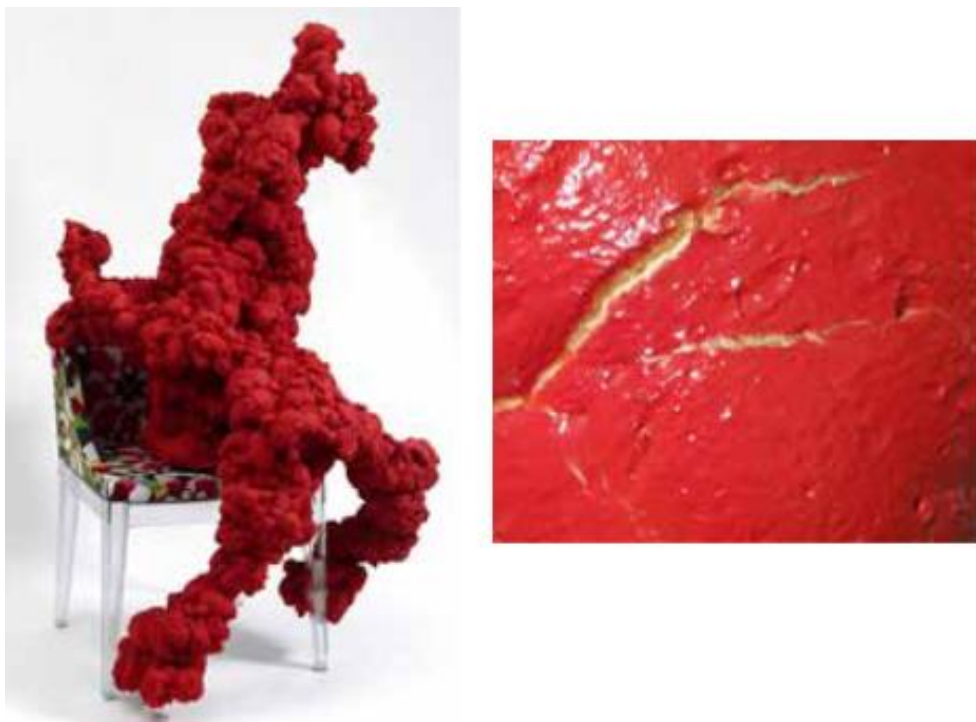
Figura 19 – Expansão térmica e fratura da camada pictórica numa escultura de espuma de poliuretano flexível provocadas pelo aquecimento, devido à incidência direta da radiação solar. Gabriela Baldomá e Gustavo Lowry, s.d., Argentina. Fonte: ICCROM; CCI; IBERMUSEOS. 2017: 44.
