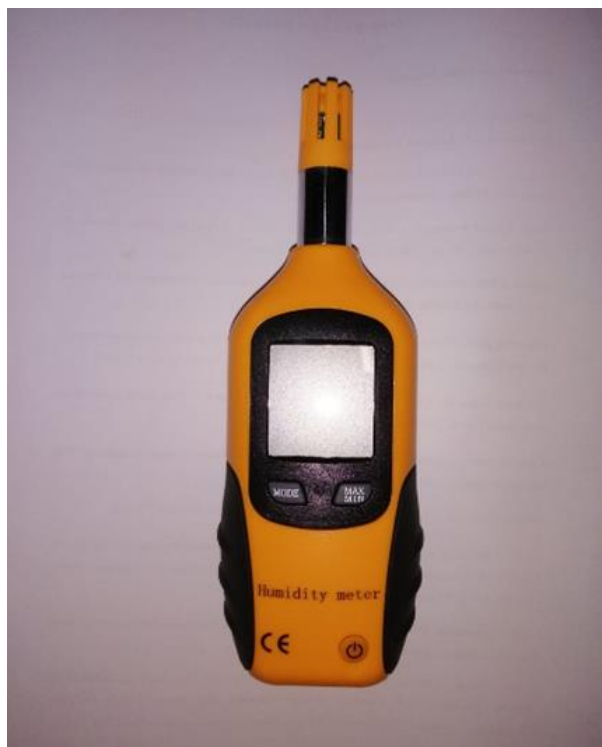
Figura 63 – Psicrómetro digital, Mengshen – Medidor de temperatura e humidade com ponto de orvalho e temperatura de bulbo húmido. Fonte: Rogério Medeiros, 2021.
