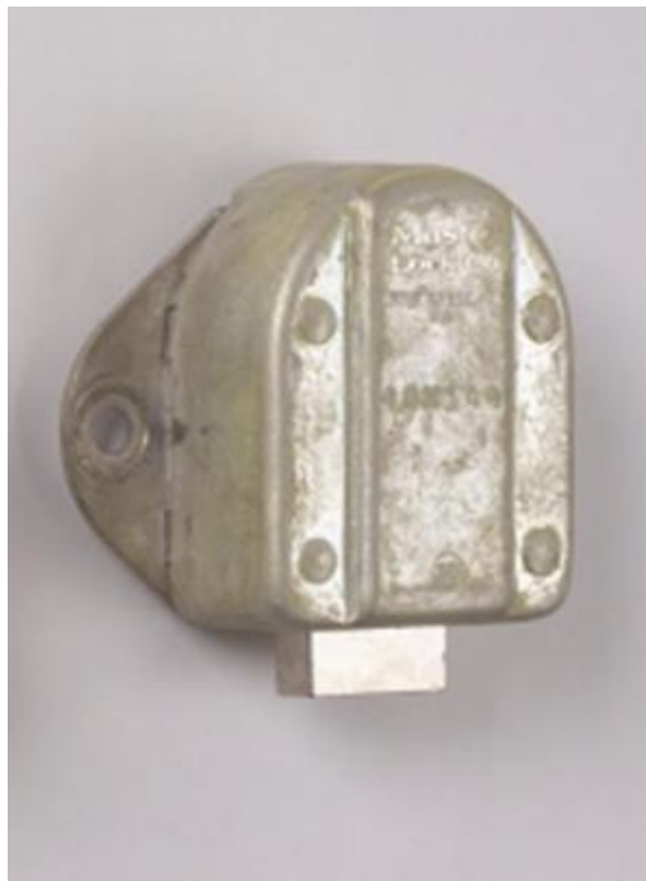
Figura 26 – Peça de ferro banhado a cádmio corroído por vapores ácidos orgânicos. Canadian Conservation Institute , 2021. Fonte: Tétreault, Jean. 2021: 26.
