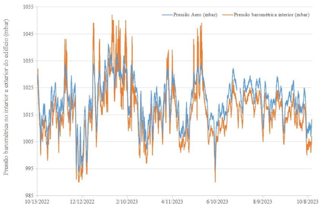
Figura 3.19 – Variação temporal da pressão barométrica no interior e no exterior do edifício amostrado para o período compreendido entre 13 de outubro de 2022 e 13 de outubro de 2023.
