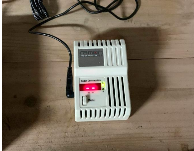
Foto 4.1 - Detetor de radão utilizado na monitorização da qualidade do ar interior de edifícios.
