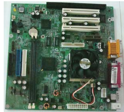
Figura V.2 – Placa principal da Unidade Central do PC.
