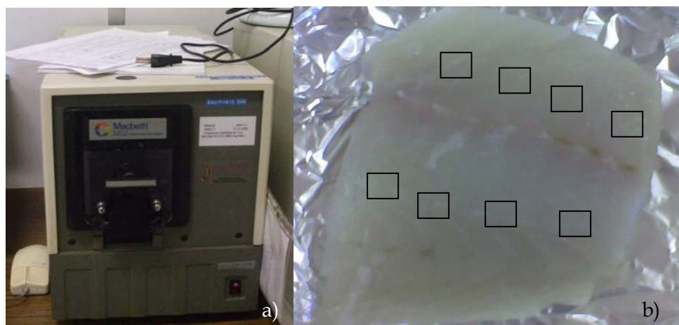
Fig. 2.3. a) Espectrocolorímetro triestímulo Macbeth Color-Eye 3000; b) Locais onde se efectuaram as medições nos filetes.
