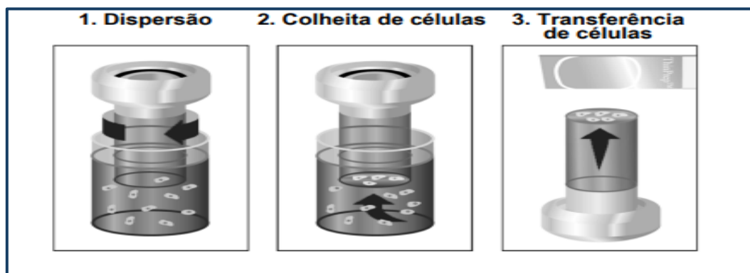
Figura 8. Processo de preparação das amostras ThinPrep®. Fonte: www.hologic.com
