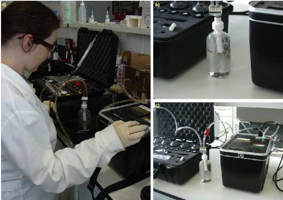
Fotografia 5.2 – Análise da concentração de radão na água: a) Equipamento montado em circuito fechado; b) processo de arejamento da amostra e c) medição da concentração de ^{222}\text{Rn} dissolvido na água.
