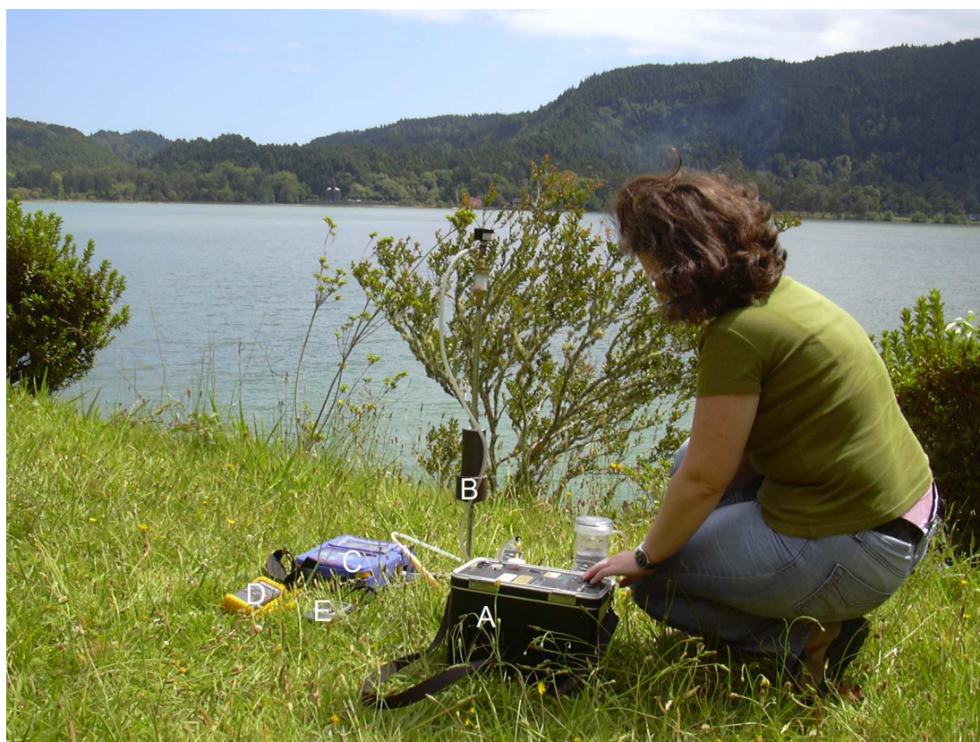
Fotografia 3.1 – Medição da concentração de ^{222}\text{Rn} no solo. Legenda: A - detector de ^{222}\text{Rn} ; B - sonda de ferro; C - detector de \text{CO}_2 ; D - termómetro e E - GPS.
