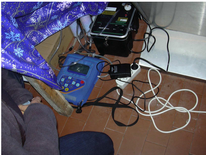
Fotografia 7.2 – Instalação dos detectores de ^{222}\text{Rn} e de \text{CO}_2 no ponto de amostragem 2.
