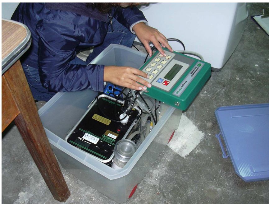
Fotografia 7.1 – Instalação dos detectores de ^{222}\text{Rn} e de CO 2 no ponto de amostragem 1.
