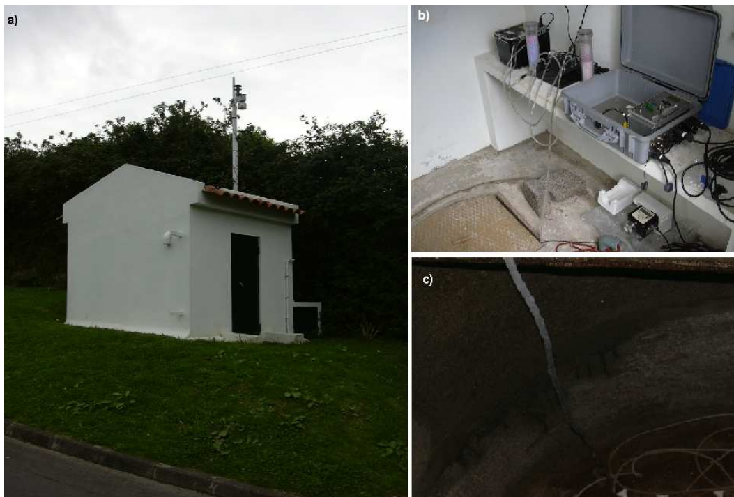
Fotografia 7.3 – Ponto de amostragem 3: a) aspecto exterior do edifício, b) equipamento utilizado para a medição de ^{222}\text{Rn} e c) poço onde foi efectuada a amostragem.
