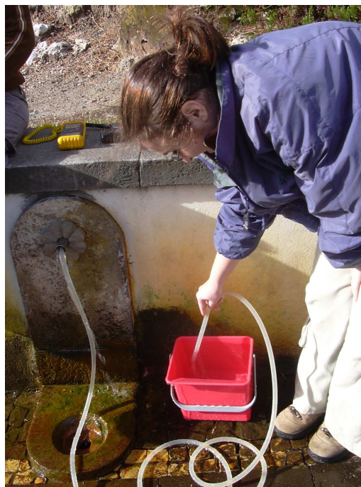
Fotografia 5.1 – Recolha de água para posterior medição da concentração de ^{222}\text{Rn} .
