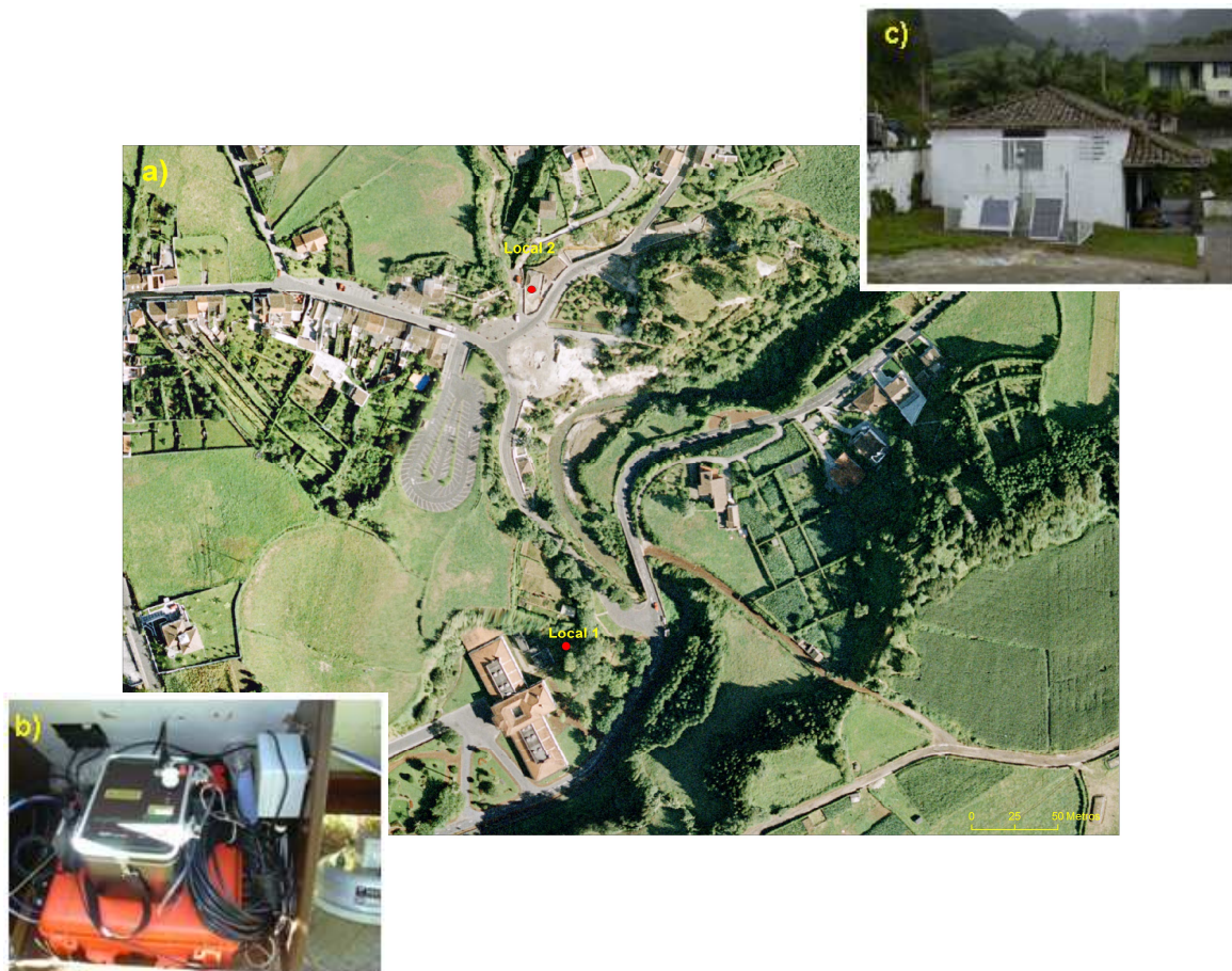
Figura 4.1 – Monitorização contínua de ^{222}\text{Rn} no solo: a) Localização dos pontos de amostragem: Local 1- Jardim do Centro Termal e Local 2- Campo fumarólico da Freguesia das Furnas; b) Estação de ^{222}\text{Rn} instalada no interior do abrigo da estação de fluxo de \text{CO}_2 GFUR1 e c) Abrigo da estação de fluxo de \text{CO}_2 GFUR3, à esquerda, e abrigo da estação de ^{222}\text{Rn} à direita.
