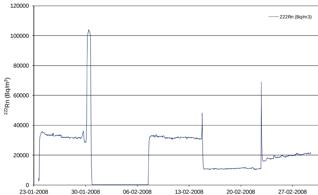
Figura 4.10 – Variação temporal da concentração de ^{222}\text{Rn} no solo no ponto de amostragem 2 localizado junto ao campo fumarólico da Freguesia das Furnas.
