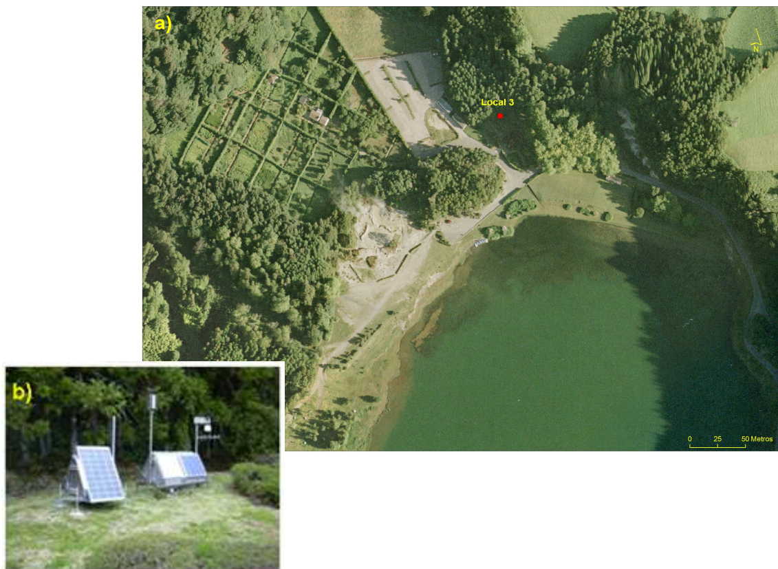
Figura 4.2 – Monitorização contínua de ^{222}\text{Rn} no solo junto ao campo fumarólico da Lagoa das Furnas: a) Localização do ponto de amostragem 3 e b) Abrigo da estação de ^{222}\text{Rn} à esquerda e abrigo da estação de fluxo de \text{CO}_2 GFUR2 à direita.
