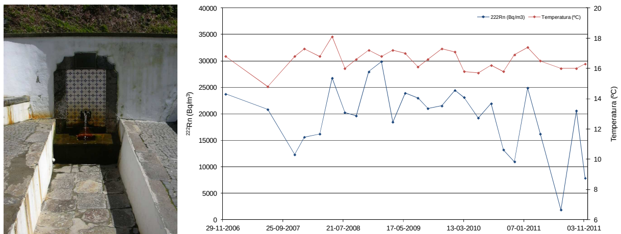
Figura 5.3 – Nascente Água Azeda: fotografia, à esquerda e variação temporal da concentração de ^{222}\text{Rn} e da temperatura nesta nascente, à direita.
