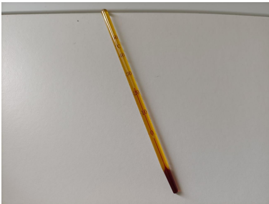
Fotografia 3.9 - Termómetro de mercúrio utilizado na medição da temperatura do solo marinho a cerca de 10 cm de profundidade.
