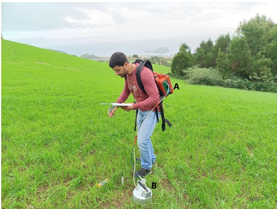
Fotografia 3.1 - Medição do fluxo de \text{CO}_2 através da A) estação portátil WS1018 equipada com B) câmara de acumulação numa das áreas de estudo.
