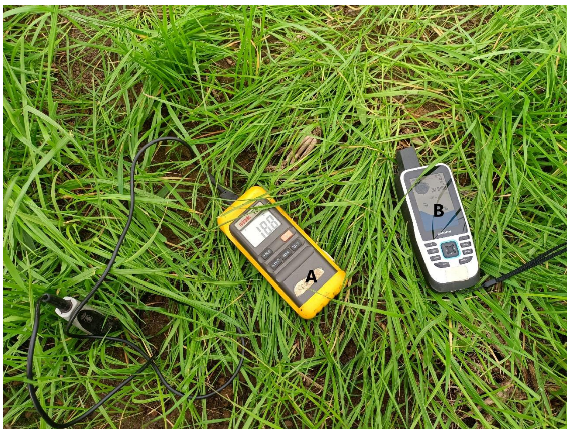
Fotografia 3.2 - A) Termómetro Rotronic T51 e B) GPSMAP® 86s utilizados na medição da temperatura do ar e do solo e georreferenciação dos pontos de amostragem, respetivamente.
