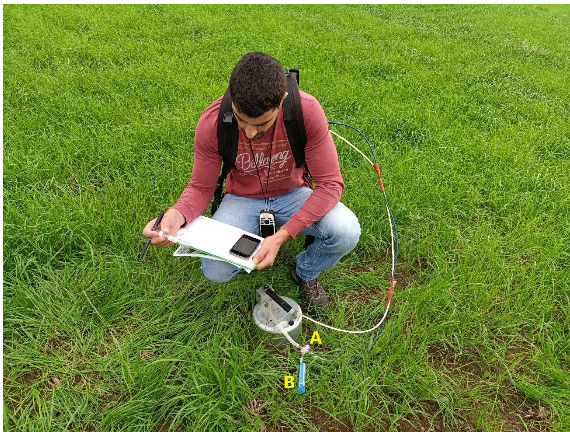
Fotografia 3.3 - Medição simultânea do fluxo de CO 2 no solo e amostragem de gás para análise isotópica posterior pela metodologia desenvolvida por Chiodini et al. (2008). Utilização da estação portátil equipada com câmara de acumulação, onde é possível observar a A) válvula de abertura e fecho e a B) seringa para a recolha de gás ao longo da tubagem de transporte de gás de retorno do sensor de infravermelhos para a câmara de acumulação.
