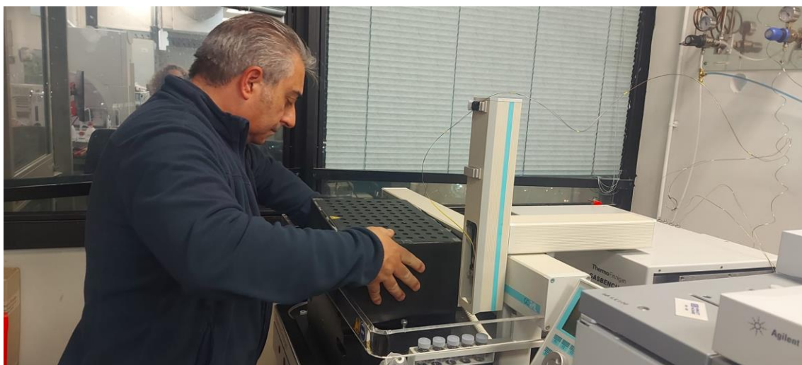
Fotografia 3.4 - Determinação isotópica de carbono no Observatório Vesuviano, do Instituto Nacional de Geofísica e Vulcanologia através do espectrômetro de massa de fluxo contínuo associado a um cromatógrafo (Agilent Technologies 6890N).
