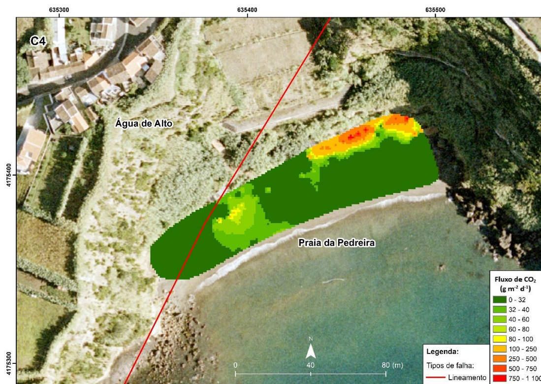
Figura 5.6 - Distribuição espacial do fluxo de \text{CO}_2 na Praia da Pedreira (C4) recorrendo à simulação sequencial Gaussiana (cartografia do tipo-E). Informação morfoestrutural baseada em Carmo (2013). Coordenadas UTM; Zona 26S; Datum WGS84.
