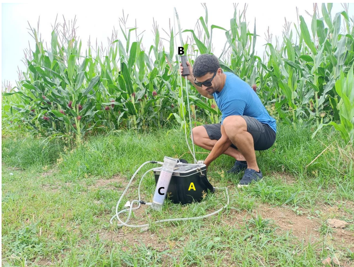
Fotografia 3.5 - Procedimento aplicado na medição da concentração de ^{222}\text{Rn} do solo na área de estudo. Legenda: A) equipamento RAD7; B) sonda de ferro; C) unidade de secagem.
