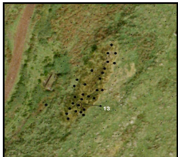
Figura 48 e 49 – Localização dos pontos de medição da temperatura – ponto preto único; localização das fumarolas – aglomerado de pontos; e identificação das fumarolas utilizadas para as medições de temperatura. Obtida em Arcgis , extensão IDW.
