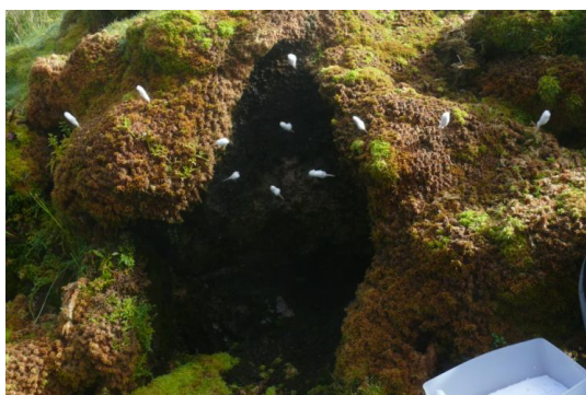
Figura 13 – Medição do vapor de água através do método dos algodões (Foto: Rita Costa).
