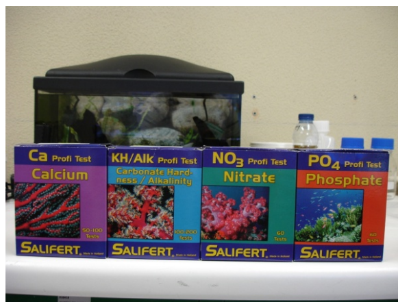
Fig. 9: Testes para realizar as medições do Cálcio, Dureza Carbonada, Nitratos e Fosfatos.
