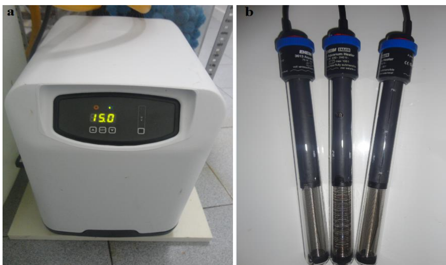
Figura 13- Sistemas de estabilização de temperatura utilizados: chiller (a) e termostatos (b).
