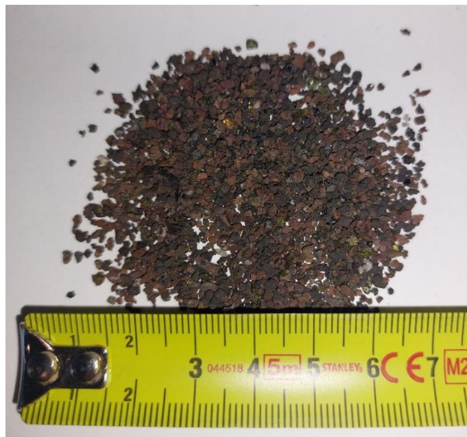
Fotografia 3.2 - Amostra SMG50s já fragmentada por moinho de maxilas.
