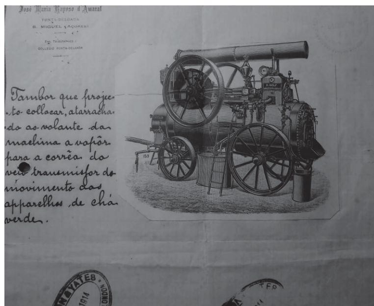
Desenho da máquina para produção de chá verde encomendada ao fornecedor britânico
